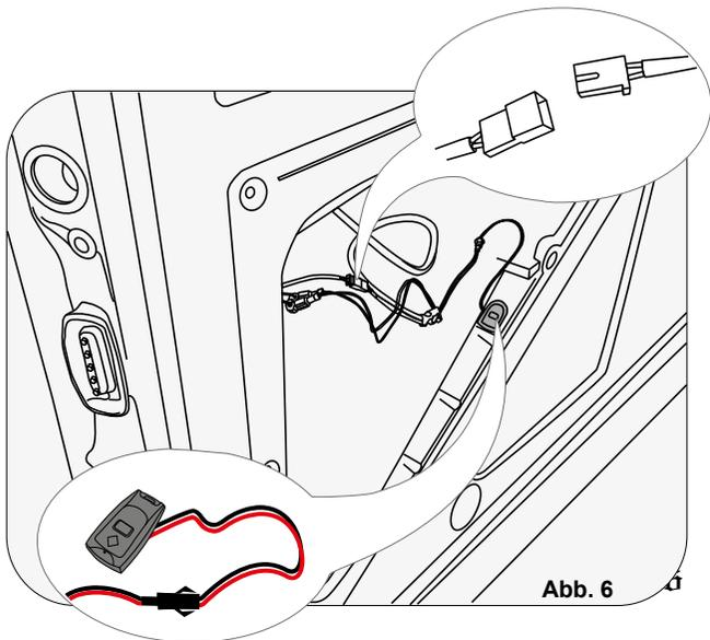
Befestigen Sie den Sender im skizzierten Bereich mit dem 3M-Klebeband. Ziehen Sie die Kabel der Schalter zu sich heran und verbinden den Sender, Abb.6.
