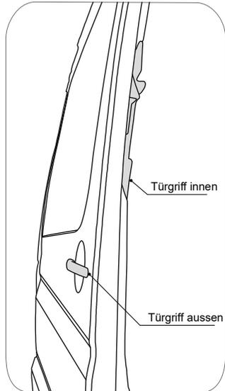
Lösen Sie den Außengriff der Schiebetür. Ziehen Sie den äußeren Griffmechanismus heraus und lösen Sie die beiden Bowdenzüge.
