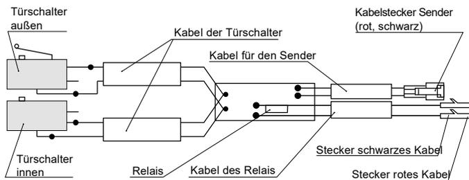
Verbinden Sie die Kabel des Senders mit dem Sender, Abb. 6.
